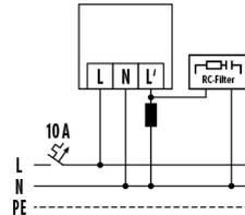
Potrebbe essere necessario un filtro RC (A) quando si collegano gli induttori (ad es. relè, contattori, ballast).
