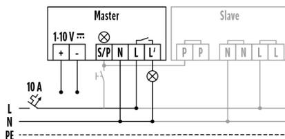
Standardbetrieb mit optionaler Ansteuerung durch Schliesstaster und Verwendung von max. 10 Slave-Geräten an einem Master-Gerät.
