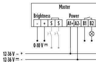
Funzionamento standard con comando opzionale tramite pulsante di chiusura.
