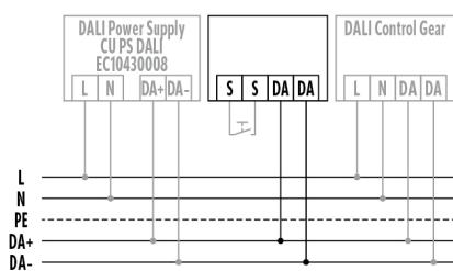
Raccordement avec commande optionnelle par poussoir.
