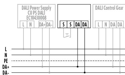
Raccordement avec commande optionnelle par poussoir.
