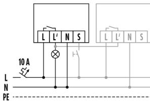
Standardbetrieb mit optionaler Ansteuerung durch Schliesstaster und Parallelschaltung von max. 8 Geräten
