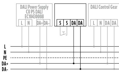
Raccordement avec commande optionnelle par poussoir.
