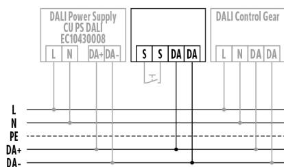
Funzionamento standard con comando opzionale tramite pulsante di chiusura.
