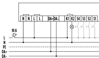
Raccordement avec commande optionnelle par poussoirs.
