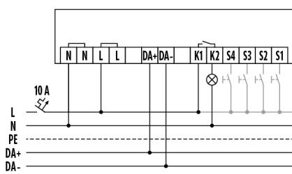
Funzionamento standard con comando opzionale tramite pulsante di chiusura.
