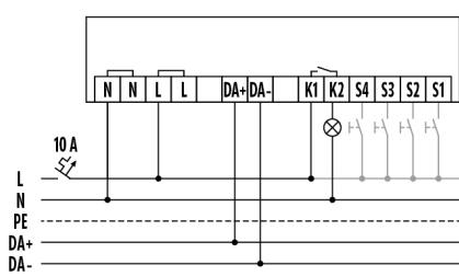
Raccordement avec commande optionnelle par pousoirs.
