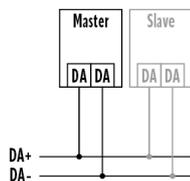
Connessione master-slave per i rilevatori di presenza: massimo 8 dispositivi slave collegabili a un dispositivo master.
