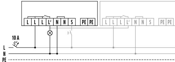
Funzionamento standard con controllo opzionale tramite pulsante di chiusura e cablaggio parallelo di max. dieci dispositivi.
