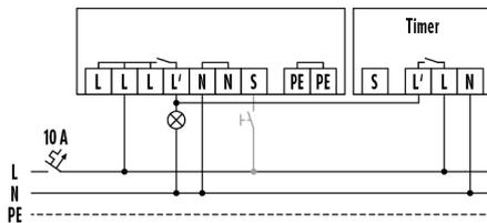
Funzionamento standard con illuminazione automatica delle scale e controllo opzionale tramite pulsante di chiusura.
