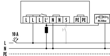
Quando si collegano gli induttori (ad esempio relè, contattori, ballast), può essere necessario utilizzare un filtro (A).
