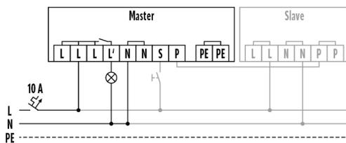
Funzionamento standard con controllo opzionale tramite pulsante di chiusura e utilizzo di max. dieci dispositivi slave con un dispositivo master
