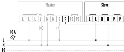
Connessione master-slave per i rilevatori di presenza: massimo 10 dispositivi slave collegabili a un dispositivo master.
