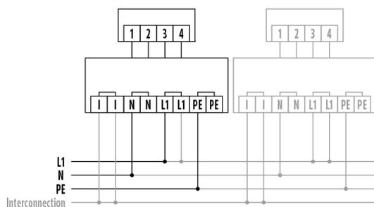
Raccordement standard. En option : réseau de 30 détecteurs max. (longueur max. du câblage 300 m). Filtre contre le parasitage du réseau pour PROTECTOR K 230 V.
