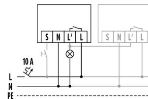
Standardbetrieb mit optionaler Ansteuerung durch Schließtaster und Parallelschaltung von max. 10 Geräten
