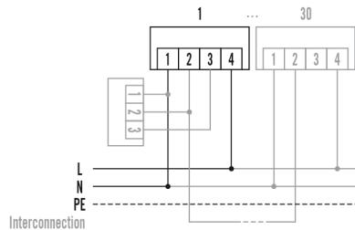
230 V Anschluss. Optional: Vernetzung mit max. 30 Meldern (max. Leitungslänge 300 m) und PROTECTOR K RELAY.
