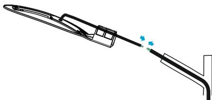
3. Setzen Sie die Leuchte in die vorgesehene Installationsöffnung ein.
