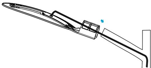
2. Entfernen Sie die Schrauben und Muttern aus den Lampenmontageanteilen.
