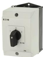
Umschalter, T0, 20 A, Aufbau, 3 Baueinheit(en), Kontakte: 6, 60 °, rastend, mit 0-Stellung, 1-0-2, Abwicklungs Nr. 8212
