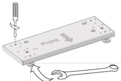
**Schritt 2** Richten Sie die Bodenstütze parallel zur Wand aus, stellen Sie sicher, dass sie 3-5 cm von der Wand entfernt ist, und legen Sie dann das erste Batteriepaket darauf.
