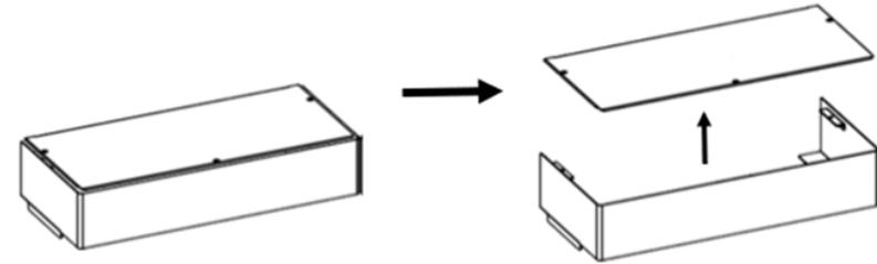
Abbildung 2. Installation der vorderen und oberen Abdeckungen
