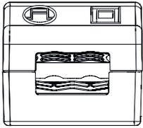
Sekundäre Zugentlastung für Kabel mit kleinerem Kabelmantel
