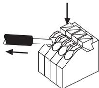
Dazu den "Drücker" an der Klemme betätigen und den Draht nach vorne abziehen.
