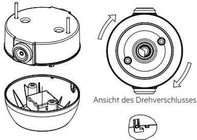
Grundplatte anbringen. Kabel (Durchmesser: 6 – 13 mm) auf den seitlichen Hülsen zu den Anschlussklemmen führen.
