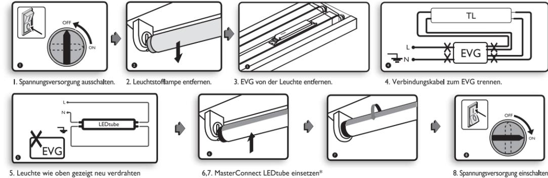
\*Stellen Sie sicher, dass die mit L/N markierte Seite der LEDtube mit der Spannungsversorgung angeschlossen wird. Anderfalls kann die LEDtube beschädigt werden.
