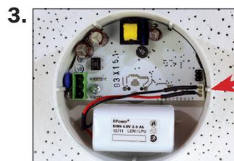
Bei Einzelbatterieversionen funktioniert die LED als **Prüftaster**.
