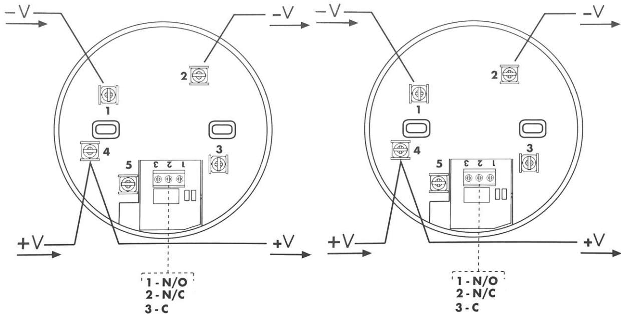
Spannungsversorgung 12V oder 24V je nach Typ (Klemme 1 und 4).
