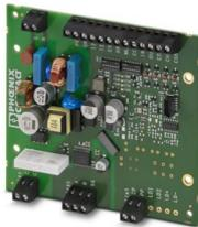
L'automate de charge EV-CC-AC1-M3-CC-SER-PCB sous forme de circuit imprimé sert à la recharge des véhicules électriques sur le réseau à courant alternatif triphasé selon la norme CEI 61851-1, Mode 3. Optimisé pour les stations de recharge avec un connecteur de charge pour véhicule, monté en fixe. Toutes les fonctions de recharge et de vastes réglages de configuration sont déjà intégrés.
