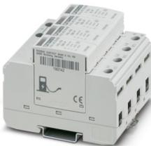
CHARX protect basic, parafoudre enfichable, conforme à type 2 / classe II, pour réseaux électriques triphasés avec conducteurs de neutre et de terre séparés (système à 5 conducteurs : L1, L2, L3, N, PE). Conçu spécialement pour une utilisation dans l'électromobilité.
