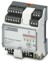
La commande EV Charge Control permet de charger les véhicules électriques sur un réseau de courant alternatif triphasé selon CEI 61851-1 mode 3. Toutes les fonctions de commande nécessaires sont intégrées. Il existe des fonctions supplémentaires pour différentes applications de charge.
