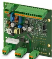
L'automate de charge EV-CC-AC1-M3-CC-SER-PCB-MSTB sous forme de circuit imprimé sert à la recharge des véhicules électriques selon la norme CEI 61851-1, Mode 3 ; il est optimisé pour les stations de recharge avec un connecteur de charge pour véhicule, monté en fixe. Raccordement via un connecteur mâle pour C.I. sur l'embase.
