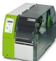
Stampante a trasferimento termico per materiale in rotolo, incl. cavo di rete Euro/US e cavo USB. Il CD di supporto contiene manuali multilingue, link a firmware, driver e software di progettazione e siglatura. Istruzioni per l'uso stampate in tedesco ed inglese. 1 rotolo di etichette EML (20x8)R bianco = 1000 etichette, nastro inchiostro = 50 m
