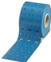
Detektierbarer Kabelmarker, Rolle, blau, unbeschriftet, beschriftbar mit: THERMOMARK E.300 (D)/600 (D), THERMOMARK ROLL 2.0, THERMOMARK ROLL, THERMOMARK ROLL X1, THERMOMARK ROLLMMASTER 300/600, THERMOMARK X1.2, Montageart: Kabelbindermontage, Kabeldurchmesser:  $\geq 6$  mm, Schriftfeldgröße: 30 x 10 mm, Anzahl der Einzelschilder: 1000
