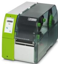
Stampante a trasferimento termico per materiale in rotolo, incl. cavo di rete Euro/US e cavo USB. Il CD di supporto contiene manuali multilingue, link a firmware, driver e software di progettazione e siglatura. Istruzioni per l'uso stampate in tedesco ed inglese. 1 rotolo di etichette EML (20x8)R bianco = 1000 etichette, nastro inchiostrato = 50 m
