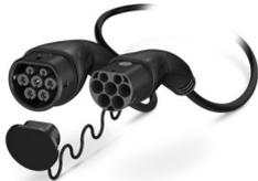
CHARX connect eco, Mobile AC-Ladeleitung, mit Fahrzeug-Ladestecker und Infrastruktur-Ladestecker, zum Laden mit Wechselstrom (AC) von Elektrofahrzeugen (EV), mit Schutzkappe, Typ 2, IEC 62196-2, 20 A / 480 V (AC), PHOENIX CONTACT-Logo, Kabel: 5 m, schwarz, gerade, Die im Lieferumfang enthaltene Schutzkappe wird auf den Fahrzeug-Ladestecker gesteckt, für den normativ ein Schutz gefordert ist.
