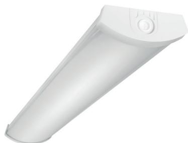
Es gibt sie in zwei Standard-Lichtstromstärken, aber dank der DIP-Schalter-Option kann der Lichtstrom manuell von 2700 bis 7400lm und bis zu 135lm/W Systemwirkungsgrad eingestellt werden. Die gebogenen Profile der Leuchten enden in Polycarbonatkappen. Der glatte, extrudierte Polycarbonatdiffusor bietet eine hohe Effizienz, die Präzisionsprismen sind für eine optimale Lichtausbeute ausgelegt.
