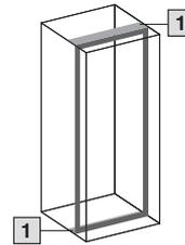
Der seitliche Einbau eines Schwenkrahmens, groß, ist bei einer Schranktiefe von 600 mm identisch mit dem Einbau parallel zur Front. Für den Zugang zum Schwenkrahmen empfehlen wir die Scharniere für die Seitenwand.
