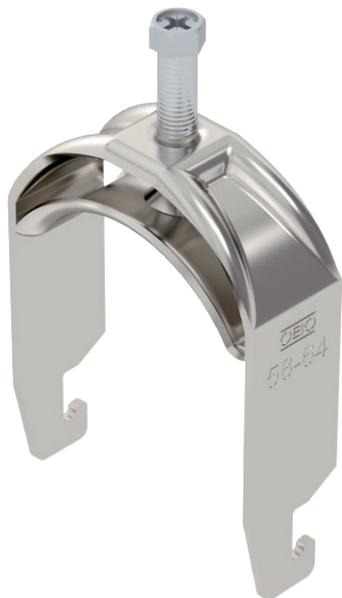
Bügelchelle mit U-Fuß, Metalldruckwanne mit gerundeten Kanten für Kabelschutz. Zur vertikalen und horizontalen Montage von 1 Einzelkabel an C-Profiltschiene. Für Schlitzweite 18 - 22 mm. Mit 1-gängiger Schraube an Druckwanne, universeller Sechskant-Schraubenkopf SW10, mit Schlitz und Kreuzschlitz. Geeignet für Montage im Innen- und Außenbereich. Der Einsatz einer Gegenwanne wird empfohlen.
