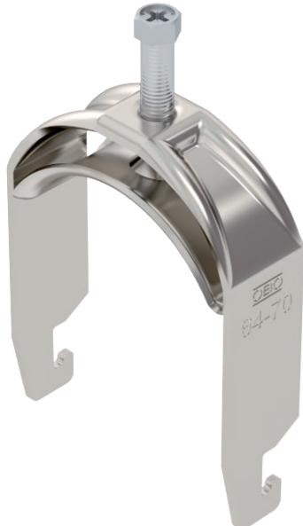
Bügelschelle mit U-Fuß, Metalldruckwanne mit gerundeten Kanten für Kabelschutz. Zur vertikalen und horizontalen Montage von 1 Einzelkabel an C-Profilsschiene. Für Schlitzweite 18 - 22 mm. Mit 1-gängiger Schraube an Druckwanne, universeller Sechskant-Schraubenkopf SW10, mit Schlitz und Kreuzschlitz. Geeignet für Montage im Innen- und Außenbereich. Der Einsatz einer Gegenwanne wird empfohlen.
