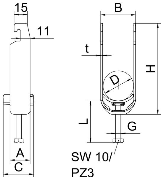
Bügelshelle mit U-Fuß, Kunststoffdruckwanne aus Polypropylen. Zur vertikalen und horizontalen Montage von 2 Einzelkabeln an C-Profilschiene. Für Schlitzweite 18 - 22 mm. Mit 1-gängiger Schraube an Druckwanne, universeller Sechskant-Schraubenkopf SW10, mit Schlitz und Kreuzschlitz. Geeignet für Montage im Innen- und Außenbereich. Mehrere Kabel müssen durch Doppelwannen getrennt werden. Gegen- und Doppelwannen müssen separat bestellt werden.
