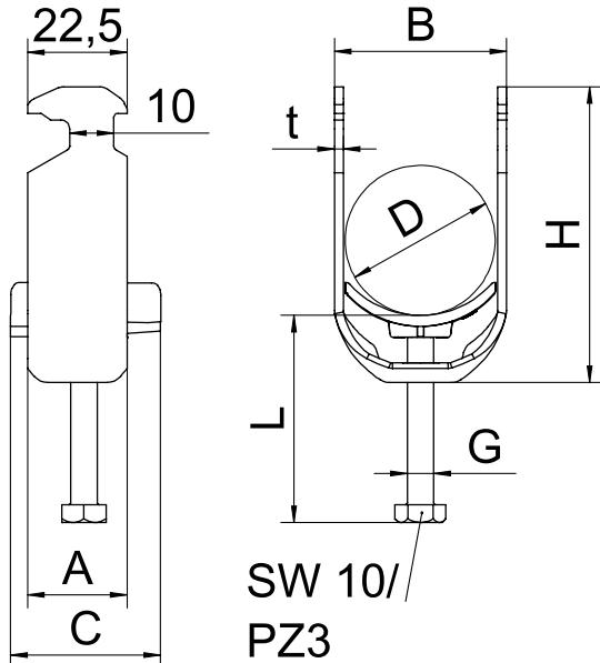
Bügelschelle mit Hammerkopf-Fuß, Kunststoffdruckwanne aus Polypropylen. Zur vertikalen und horizontalen Montage von 1 Einzelkabel an C-Proflschiene. Für Schlitzweite 16 - 17 mm. Mit 1-gängiger Schraube an Druckwanne, universeller Sechskant-Schraubenkopf SW10, mit Schlitz und Kreuzschlitz. Geeignet für Montage im Innen-und Außenbereich. Gegenwanne muss separat bestellt werden.
