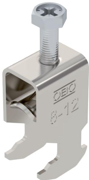
Bügelshelle mit Hammerkopf-Fuß, Metalldruckwanne mit gerundeten Kanten für Kabelschutz. Zur vertikalen und horizontalen Montage von 1 Einzelkabel an C-Profilschiene. Für Schlitzweite 16 - 17 mm. Mit 1-gängiger Schraube an Druckwanne, universeller Sechskant-Schraubenkopf SW10, mit Schlitz und Kreuzschlitz. Geeignet für Montage im Innen- und Außenbereich. Der Einsatz einer Gegenwanne wird empfohlen.
