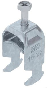
Bügelschelle mit Hammerkopf-Fuß, Metalldruckwanne mit gerundeten Kanten für Kabelschutz. Zur vertikalen und horizontalen Montage von 1 Einzelkabel an C-Profilschiene. Für Schlitzweite 16 - 17 mm. Mit 1-gängiger Schraube an Druckwanne, universeller Sechskant-Schraubenkopf SW10, mit Schlitz und Kreuzschlitz. Geeignet für Montage im Innen-und Außenbereich. Gegenwanne muss separat bestellt werden.
