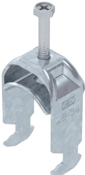
Bügelschelle mit Hammerkopf-Fuß, Metalldruckwanne mit gerundeten Kanten für Kabelschutz. Zur vertikalen und horizontalen Montage von 1 Einzelkabel an C-Proflschiene. Für Schlitzweite 16 - 17 mm. Mit 1-gängiger Schraube an Druckwanne, universeller Sechskant-Schraubenkopf SW10, mit Schlitz und Kreuzschlitz. Geeignet für Montage im Innen- und Außenbereich. Gegenwanne muss separat bestellt werden.
