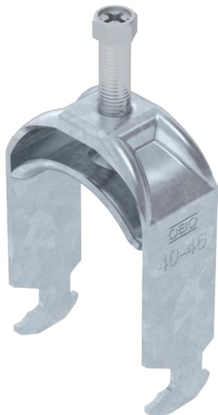
Bügelshelle mit Hammerkopf-Fuß, Metalldruckwanne mit gerundeten Kanten für Kabelschutz. Zur vertikalen und horizontalen Montage von 1 Einzelkabel an C-Profilschiene. Für Schlitzweite 16 - 17 mm. Mit 1-gängiger Schraube an Druckwanne, universeller Sechskant-Schraubenkopf SW10, mit Schlitz und Kreuzschlitz. Geeignet für Montage im Innen- und Außenbereich. Gegenwanne muss separat bestellt werden.
