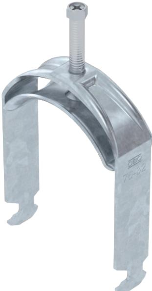
Bügelschelle mit Hammerkopf-Fuß, Metalldruckwanne mit gerundeten Kanten für Kabelschutz. Zur vertikalen und horizontalen Montage von 1 Einzelkabel an C-Proflschiene. Für Schlitzweite 16 - 17 mm. Mit 1-gängiger Schraube an Druckwanne, universeller Sechskant-Schraubenkopf SW10, mit Schlitz und Kreuzschlitz. Geeignet für Montage im Innen- und Außenbereich. Gegenwanne muss separat bestellt werden.
