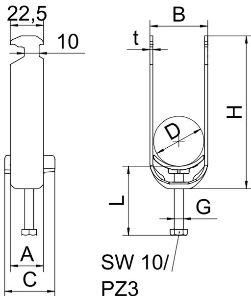
Bügelshelle mit Hammerkopf-Fuß, Kunststoffdruckwanne aus Polypropylen. Zur vertikalen und horizontalen Montage von 2 Einzelkabeln an C-Profilshiene. Für Schlitzweite 16 - 17 mm. Mit 1-gängiger Schraube an Druckwanne, universeller Sechskant-Schraubenkopf SW10, mit Schlitz und Kreuzschlitz. Geeignet für Montage im Innen- und Außenbereich. Mehrere Kabel müssen durch Doppelwannen getrennt werden. Gegen- und Doppelwannen müssen separat bestellt werden.
