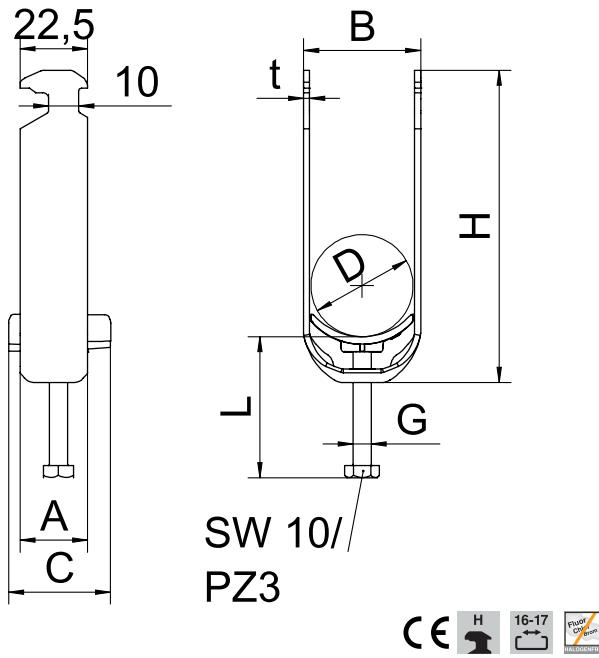
Bügelschelle mit Hammerkopf-Fuß, Kunststoffdruckwanne aus Polypropylen. Zur vertikalen und horizontalen Montage von 2 Einzelkabeln an C-Proflschiene. Für Schlitzweite 16 - 17 mm. Mit 1-gängiger Schraube an Druckwanne, universeller Sechskant-Schraubenkopf SW10, mit Schlitz und Kreuzschlitz. Geeignet für Montage im Innen- und Außenbereich. Mehrere Kabel müssen durch Doppelwannen getrennt werden. Gegen- und Doppelwannen müssen separat bestellt werden.
