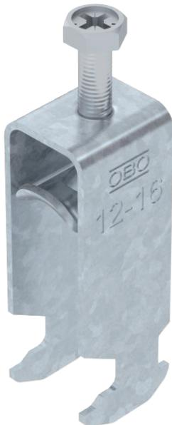
Bügel­schelle mit Hammerkopf-Fuß, Metall­druckwanne mit gerundeten Kanten für Kabelschutz. Zur vertikalen und horizontalen Montage von 2 Einzelkabeln an C-Profil­schiene. Für Schlitzweite 16 - 17 mm. Mit 1-gängiger Schraube an Druckwanne, universeller Sechskant-Schraubenkopf SW10, mit Schlitz und Kreuzschlitz. Geeignet für Montage im Innen- und Außenbereich. Mehrere Kabel sollten durch Doppelwannen getrennt werden. Der Einsatz einer Gegenwanne wird empfohlen.
