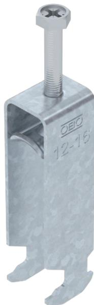
Bügel­schelle mit Hammerkopf-Fuß, Metall­druckwanne mit gerundeten Kanten für Kabelschutz. Zur vertikalen und horizontalen Montage von 3 Einzelkabeln an C-Profil­schiene. Für Schlitzweite 16 - 17 mm. Mit 1-gängiger Schraube an Druckwanne, universeller Sechskant-Schraubenkopf SW10, mit Schlitz und Kreuzschlitz. Geeignet für Montage im Innen- und Außenbereich. Mehrere Kabel sollten durch Doppelwannen getrennt werden. Der Einsatz einer Gegenwanne wird empfohlen.
