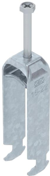
Bügelwelle mit Hammerkopf-Fuß, Metalldruckwanne mit gerundeten Kanten für Kabelschutz. Zur vertikalen und horizontalen Montage von 3 Einzelkabeln an C-Profilwelle. Für Schlitzweite 16 - 17 mm. Mit 1-gängiger Schraube an Druckwanne, universeller Sechskant-Schraubenkopf SW10, mit Schlitz und Kreuzschlitz. Geeignet für Montage im Innen- und Außenbereich. Mehrere Kabel sollten durch Doppelwannen getrennt werden. Der Einsatz einer Gegenwanne wird empfohlen.
