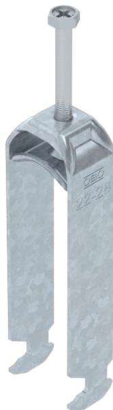
Bügelshelle mit Hammerkopf-Fuß, Metalldruckwanne mit gerundeten Kanten für Kabelschutz. Zur vertikalen und horizontalen Montage von 3 Einzelkabeln an C-Profilshiene. Für Schlitzweite 16 - 17 mm. Mit 1-gängiger Schraube an Druckwanne, universeller Sechskant-Schraubenkopf SW10, mit Schlitz und Kreuzschlitz. Geeignet für Montage im Innen- und Außenbereich. Mehrere Kabel sollten durch Doppelwannen getrennt werden. Der Einsatz einer Gegenwanne wird empfohlen.
